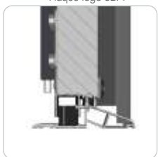
Seuil aluminium 20mm vue coupe basse
